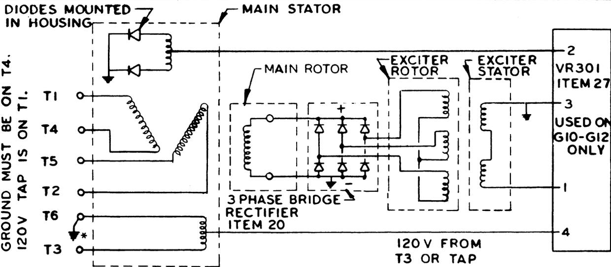
NOTE: 60Hz - 200 UNITS USE CM100 CONTROL MODULE & USER'S GROUND MUST BE ON T4. 120V TAP IS ON T1.
