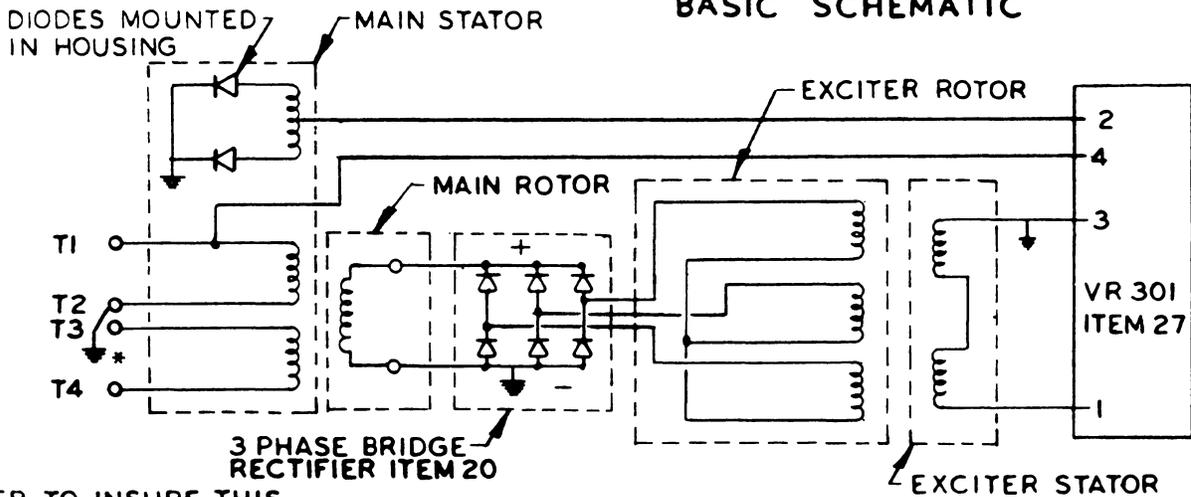
\* USER TO INSURE THIS GROUND CONNECTION IS MADE. SINGLE PHASE (ALL)
